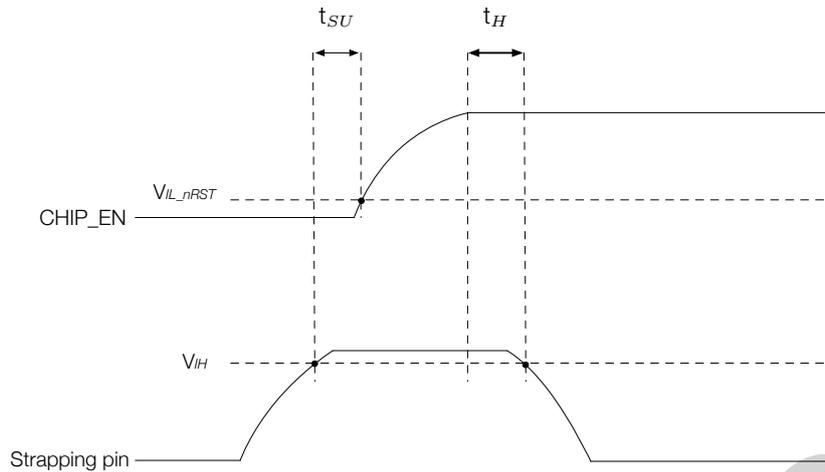
图 2-5. Strapping 管脚的时序参数图
