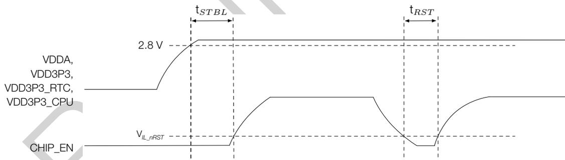
图 2-4. 上电和复位时序参数图
